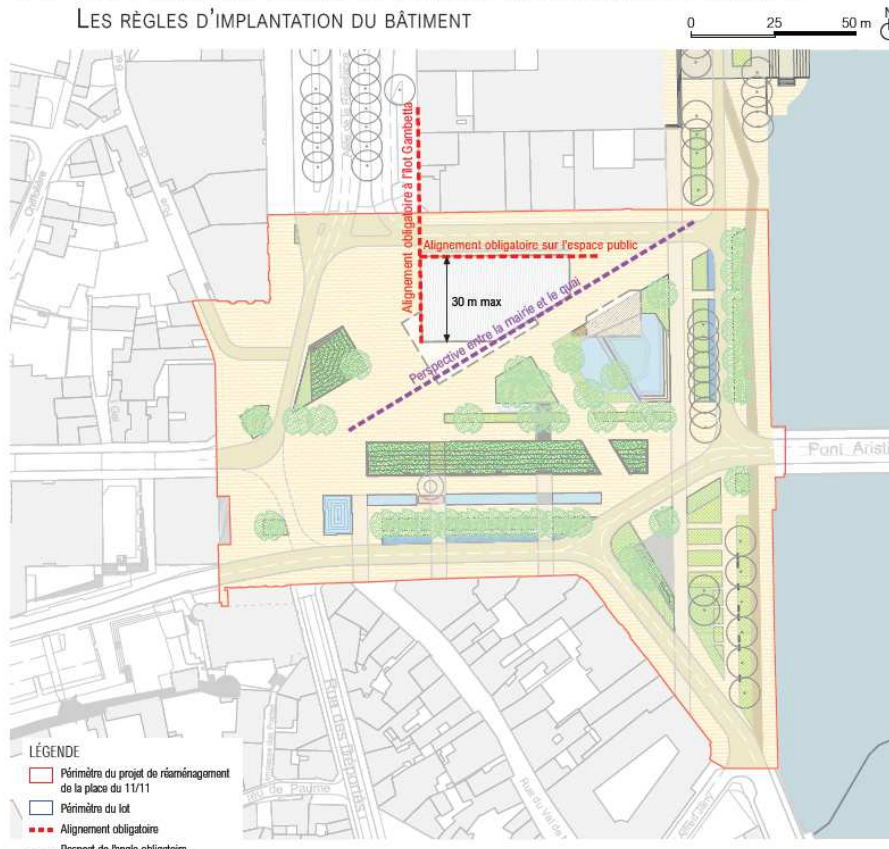
Fig. 19 : les règles d'implantation validées par l'ABF figurant dans la fiche de lot
